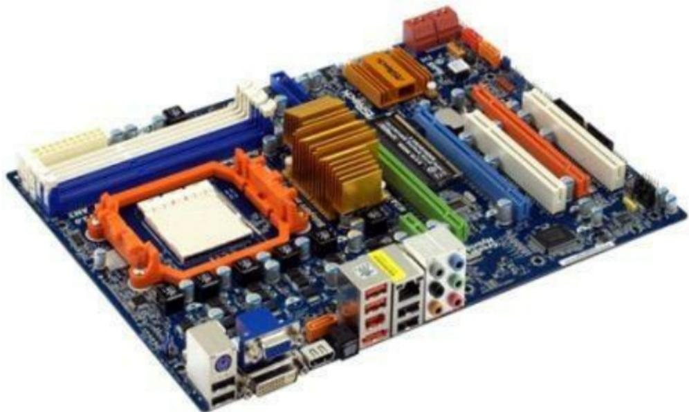
Figura 2.28 – A placa-mãe de um computador.
