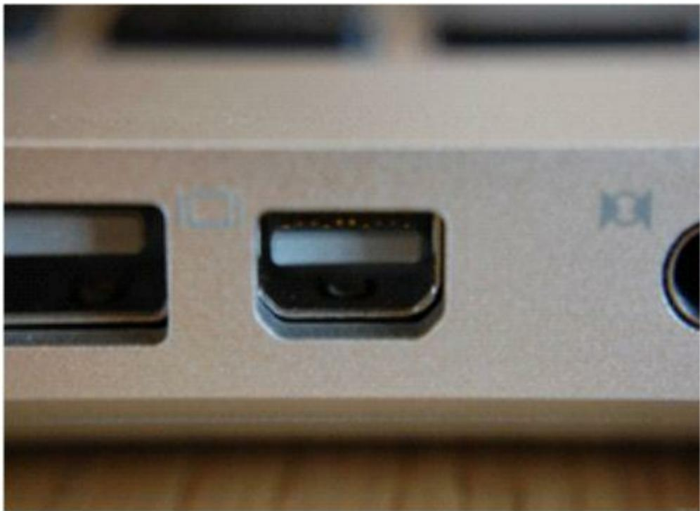
*Figura 2.82 – Conector Mini Display Port, em computador Apple®.*
