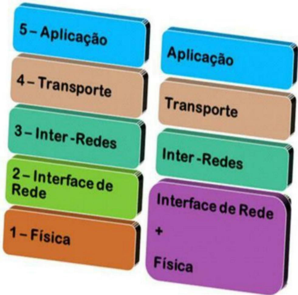
Figura 8.65 – Modelos de camadas TCP/IP.
