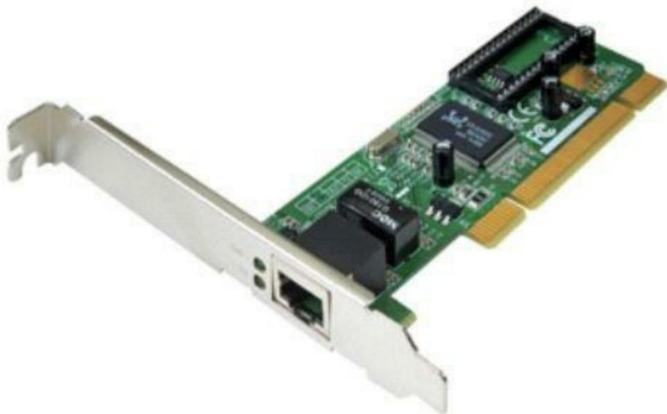
Figura 2.77 – Placa de rede Ethernet (interna ao gabinete).
