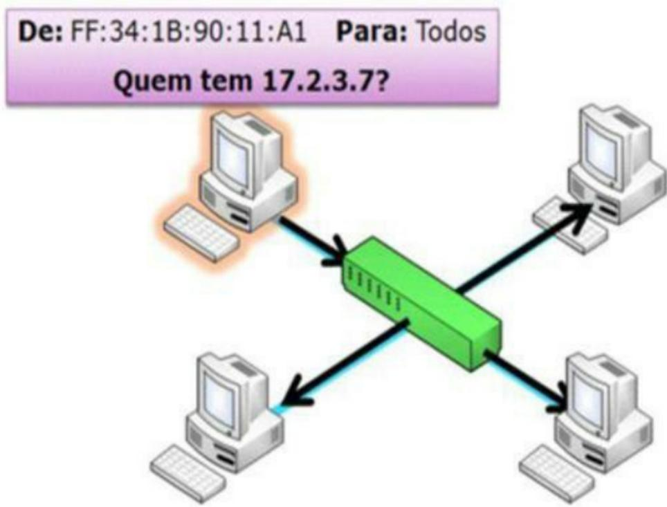
Figura 8.75 – Uma mensagem ARP Request (Requisição ARP).
