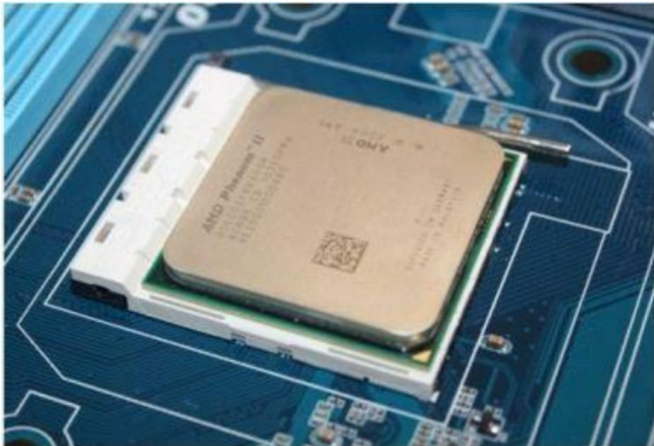
*Figura 2.27 – Processador AMD Phenom II.*
