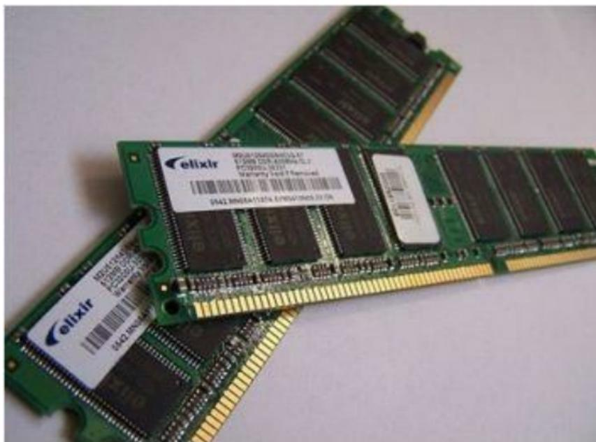
Figura 2.9 – Um pente (módulo) de memória RAM – usado como memória principal.
