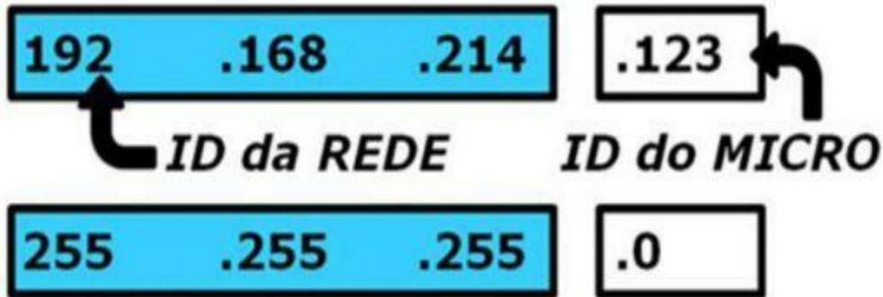
Figura 8.68 – Analisando o IP 192.168.214.123 na máscara 255.255.255.0.
