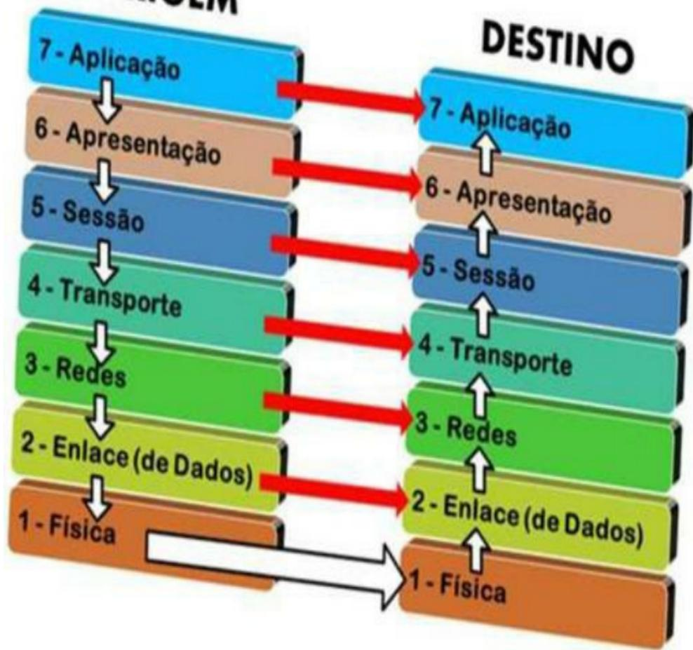
Figura 8.60 – Comunicação analisada pelo modelo OSI.
