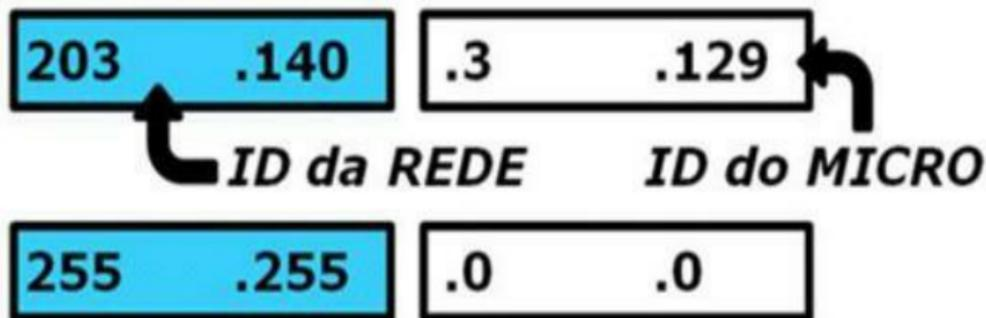
Figura 8.69 – Analisando o IP 203.140.3.129 na máscara 255.255.0.0 (classe B).
