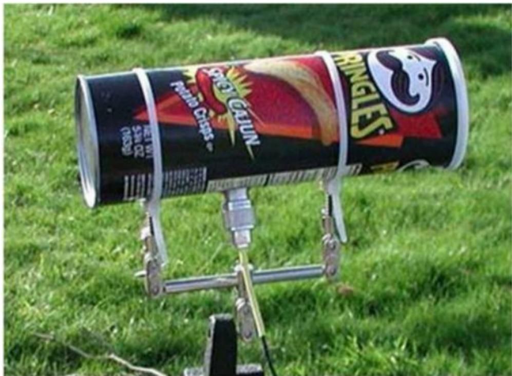
Figura 8.38 – Antena direcional feita com lata de batatas.
