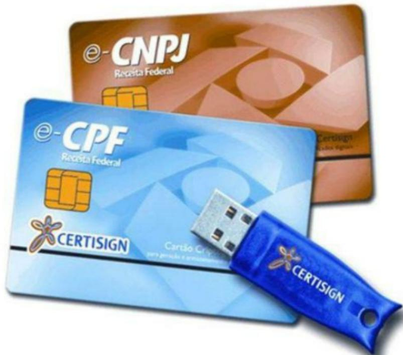
Figura 10.16 – Smart cards criptográficos (armazenando o e-CPF) e token USB.
